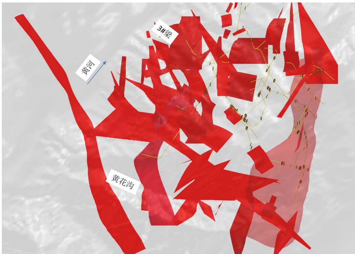
以岸坡断层地表露头线创建的三维模型
