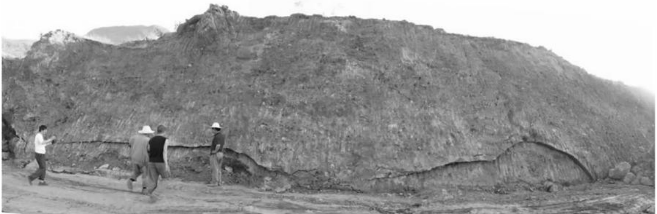
图六：滑坡的剪出口
