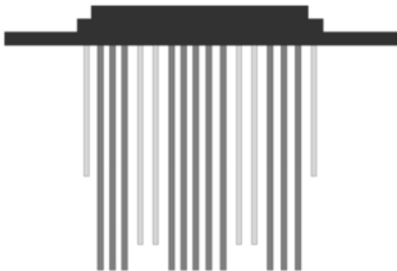
图 7.1 桩与筏板联合变调平设计概化示意图
