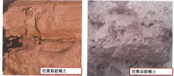
注浆前后桩端土的变化
