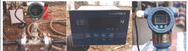
(a) SBL靶式流量计 (b) XK3101称重计 (c) JSDC-60压力传感器
