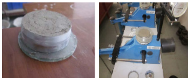
图 4 土体固结试验 Fig.4 Consolidation test of soil
